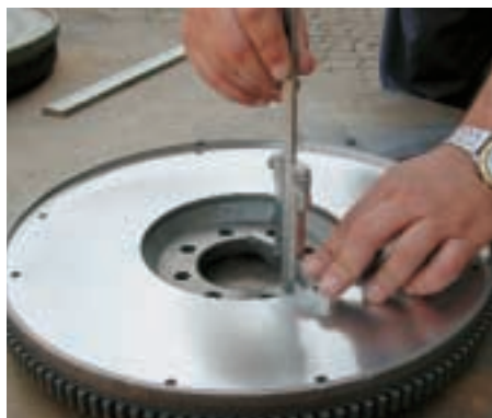
Verificação da profundidade do volante
