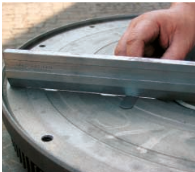
Verificação da planicidade
